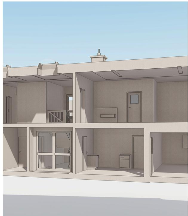
**ING PLUS hat ein 3D-BIM-Modell eines Kindergartens in Uster, basierend auf eines 3D-Laserscannings, modelliert. Die erfasste Punktwolke diente dabei als Grundlage für die 3D-Modellierung.**
