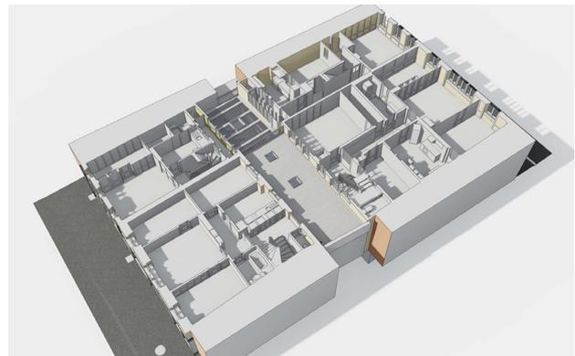
Im Herzen der Altstadt Winterthurs hat ING PLUS von vier Stadthäusern eine Gebäudeaufnahme mit 3D-Laserscanning über bis zu sechs Stockwerken ausgeführt. Aus der 3D-Vermessung wurde anschliessend ein präzises 3D-Modell in ArchiCAD modelliert.
